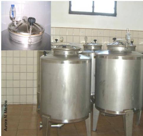
Fig. 3 – Fermentadores em inox com controlo de saída de CO<sub>2</sub>.
