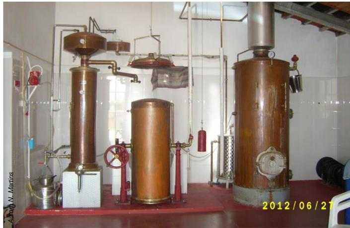
Fig. 4 – Sistema de destilação por arraste de vapor.
